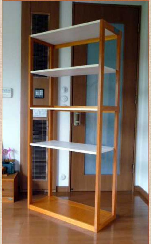
**忘備録：** 棚板ダボピン（6 × 8 ）穴加工で、6 ドリル穴では少し緩いので、5.8 ダボ穴ドリルで開けたら、さすがに少しい。塗装後ダボピンを一旦叩き込むと、穴の角部も内側に丸め込まれ、きれいな穴に仕上がる。ピンの嵌合も少しいつめで Good だった。
